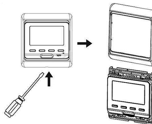
7.2.2. Передвинув вверх проволочную рамку, снимите нижнюю крепежную пластину
